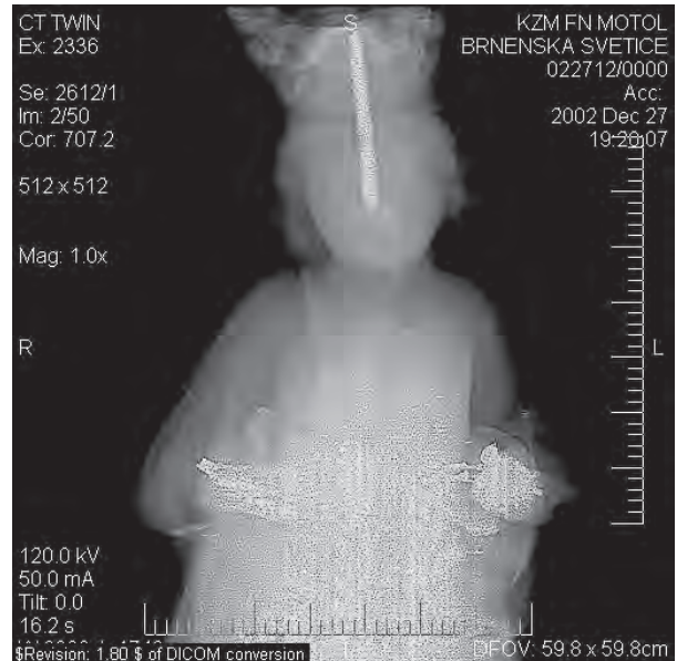
CT vyšetření, měkčí výplň kolem plného hřebu upevňujícího korunu k hlavě
