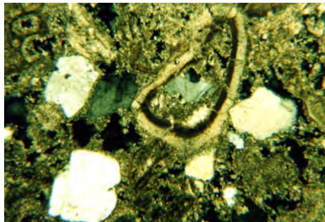
Vápenec biotrický bryozoový, středně zrnitý klastický křemen, biotrit (řasy)
