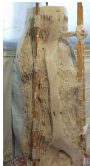
Nosná konstrukce přední části formy.
