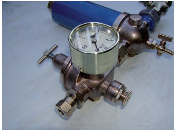
Sestava redukce tlaku s filtrem, po restaurování, detailní pohled.
