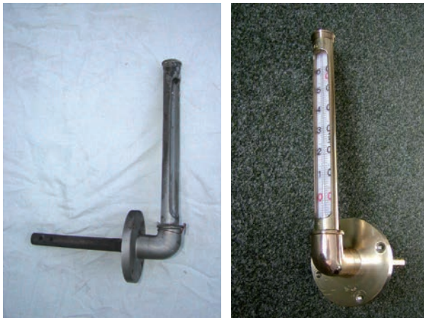
Rtuťový teploměr strojovny, před restaurováním. Rtuťový teploměr strojovny, po restaurování.
