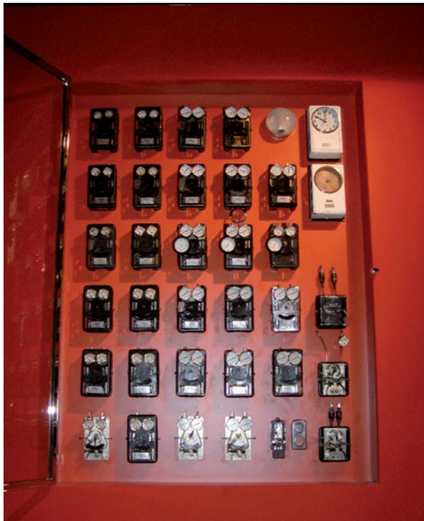
Restaurované měřicí a regulační přístroje vzduchotechniky celé budovy.
