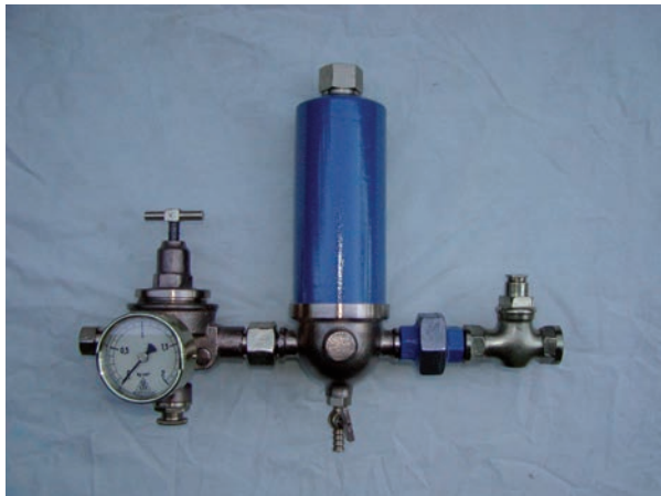
Sestava redukce tlaku s filtrem, po restaurování, celkový pohled.
