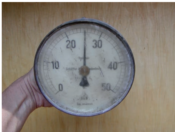
Bimetalický teploměr strojovny, před restaurováním.
