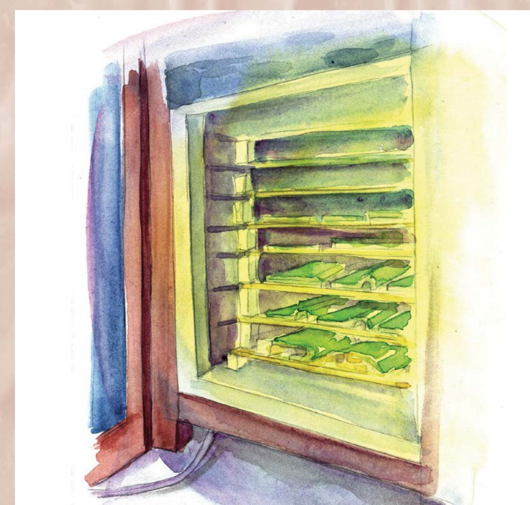
Nakládka naglazovaných polotovarů v elektrické peci před druhým ostrým výpalem
