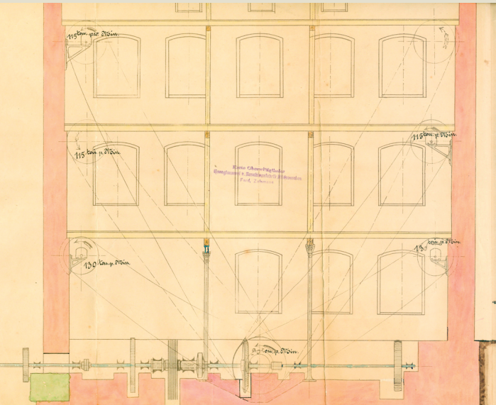
Plán rozvodů pohonu z r. 1902 – řez (Lužská slévárna a strojírna Ferdinanda Zelsmanna)
