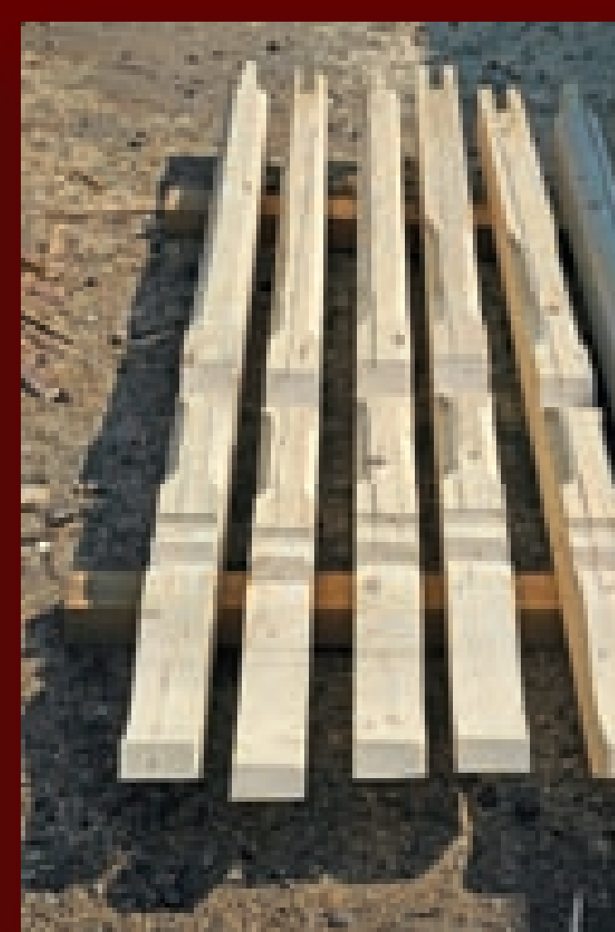
↑ Profilace krokví věže byly kontrolovány ještě před sestavením krovu. Rovněž ozdobné lišty byly ověřeny na vzorcích vyrobených v poměru 1 : 1.
