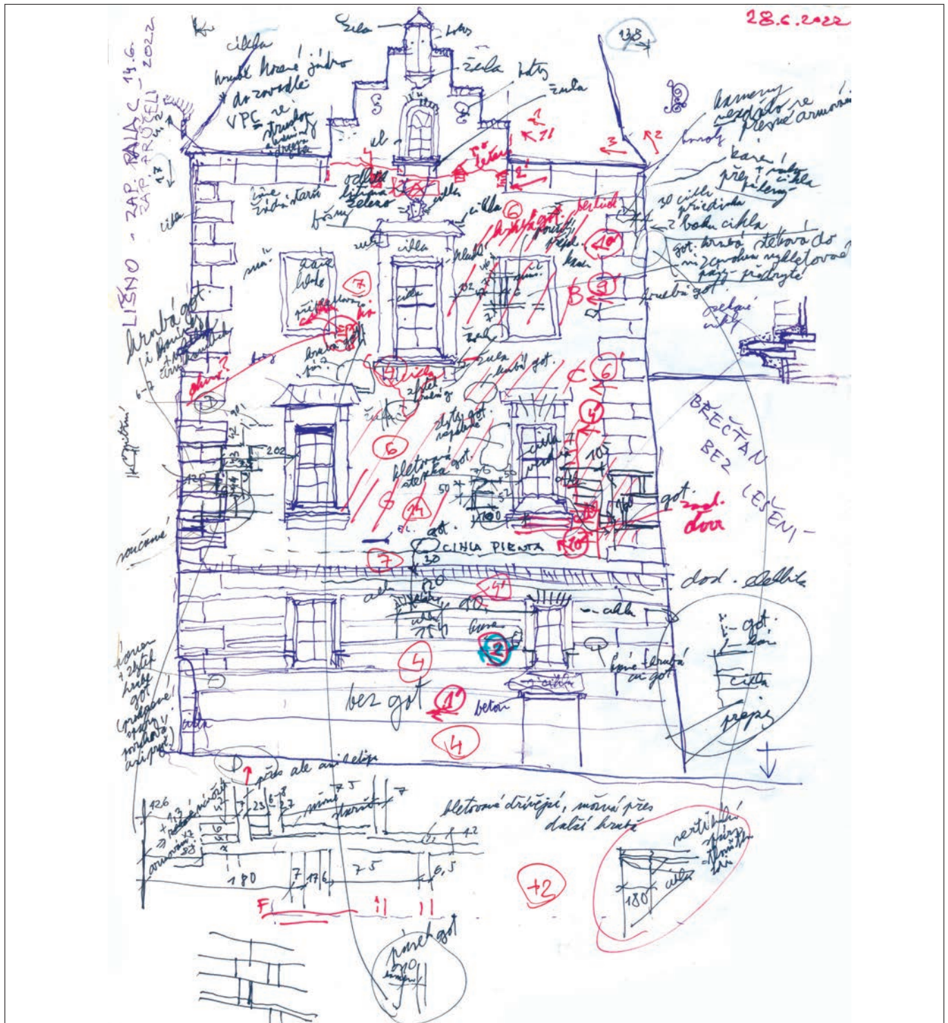
Líšno (okres Benešov), zámek západní palác čp. 1, západní průčelí – Poměrně rozsáhlá, mnohvrstevnatá fasáda s velkým množstvím nálezů od miniaturních zbytků až k velkým plochám středověkých a mladších omítek, zazděných otvorů, ostění i druhů zdíva musí být zaznamenána z lešení v poměrně velkém chvatu. Originální autorské terénní skici mohou pak působit chaoticky, ale spolu s podrobnou fotodokumentací a paměti zpracovatele jsou kupodivu efektivním nástrojem pro zpracování přehledné finální nálezové zprávy a dokumentace (kresba V. Jesenský, 2022).
