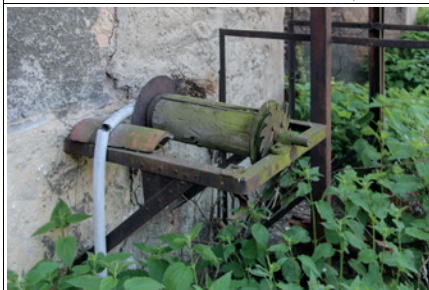
009 – Mechanismus ručního pohonu vrátku
