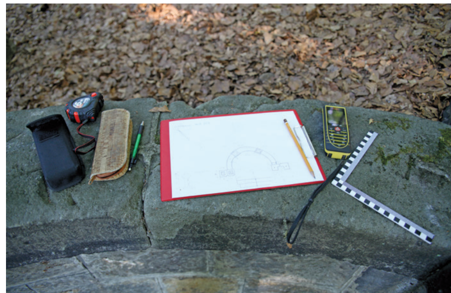
4.10 Pomůcky pro ruční stavební měření: svinovací metr, terénní zápisník, laserový metr s nivelací, pravoúhlé fotografické měřítko. Dokumentaci usnadní využití laserového nivelačního kříže a fotoaparátu s digitálním horizontem, foto: David Skalický 2018.
