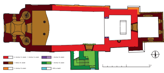
Půdorys na úrovni přízemí věže s vyhodnocením stavebního vývoje. Zaměření: Jaroslav Skopec a Tomáš Brož, 2012–2020; vyhodnocení: Jaroslav Skopec, 2021.
