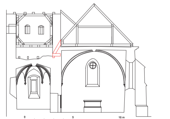
Příčný řez presbytářem a sakristií s věží s pohledem k východu. Červeně jsou zvýrazněny kapsy po pozednicích, krátcích a krokech středověkého krovu, jejichž prvky byly zadrženy do renesanční nástavby věže. Zaměření: Jaroslav Skopec a Miroslav Nový, 2018. Kresba: Jaroslav Skopec, 2019.
