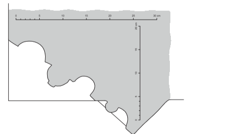
Profil východní stojky s lištou rámujiící archivoltu a horní část stojek jižního portálu patrové předsíň. Zaměření a kresba: Tomáš Braž, 2013.
