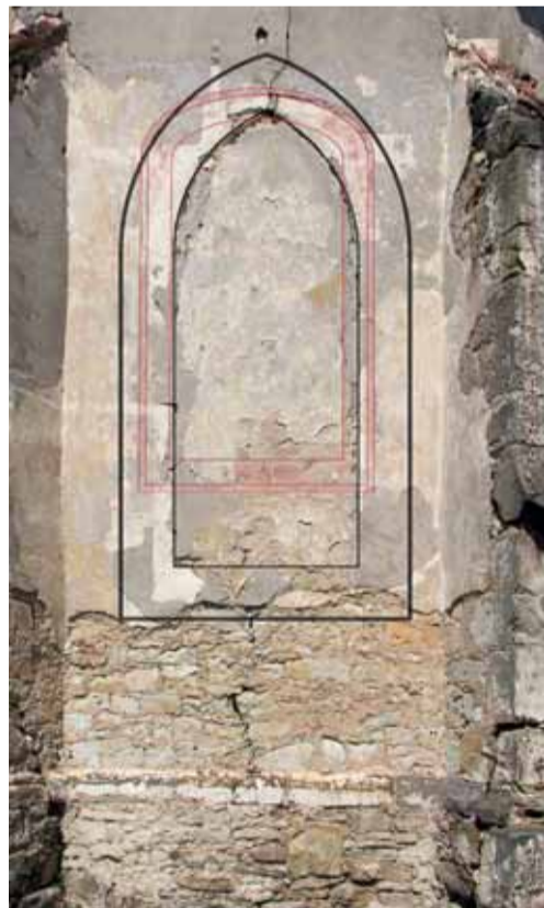
Fotoplán jihovýchodního pole závěru presbytáře se zázřemem rekonstruované podoby šedě malované šambrány kolem hrotitého okenního otvoru (černě) a malovaného barokního iluzivního okenního otvoru s páslem (červeně). Fotoplán sestavil: Jaroslav Skopec, 2018.
