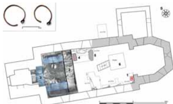
Celková názevová situace v kostele: 1 – hrob datovaný do 12. století porušený základem kostela a obsahující dvě esovitě zdušněné (ve výřezu), 2 – základ středověké západní zdi lodi, 3 – základ starší věže, 4 – dřevěná kovaná bedna uložená pod úroveň podlahy, 5 – kamenný náhrobní kámen, 6 – novověké krypta. Autor plánu: Vojtěch Peksa, 2015.
