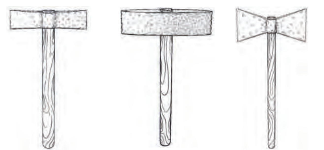
Gotické sekery. Topůrkové sekery s plochými zuby jsou typickými nástroji gotického období. Většinou se šířka ostří pohybuje mezi 5 až 10 cm. Autor kresby: Anna Musilová, 2022.
