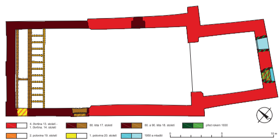
Půdorys na úrovni vstupních otvorů s vyhodnocením stavebního vývoje. Zaměření: Jaroslav Skopec, Tomáš Braž, Miroslav Nový, 2007–2019; vyhodnocení: Jaroslav Skopec, 2021.
